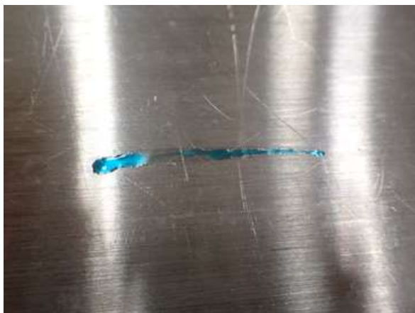
濡れ性試薬を塗布したワーク ワークは撥かれずに濡れている
