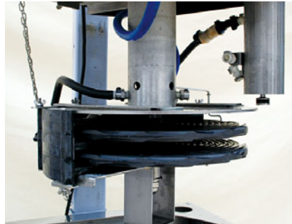
ウイザード本体に取められたUF膜カセットとスパイラル溝付きの回転ディスク
